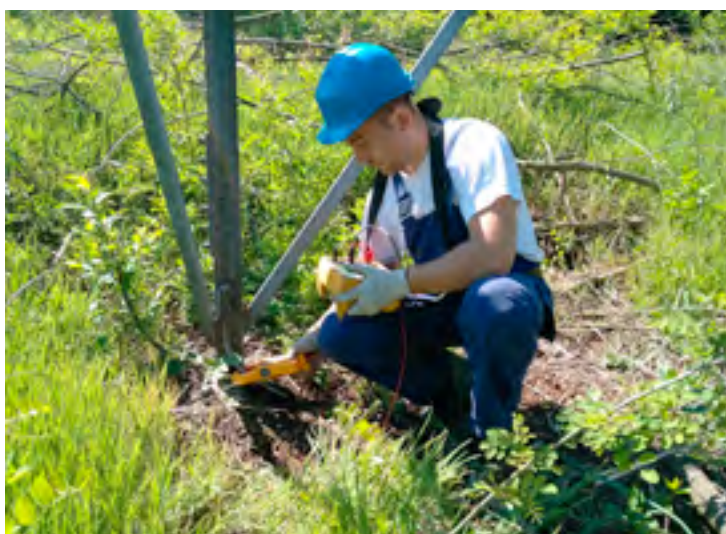
Slika 3. Bojan Kuzmanović, TJ Doboj – mjerenje otpora uzemljenja
