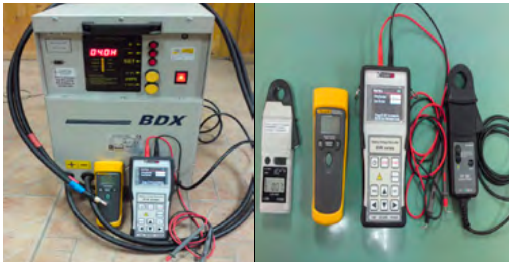
Slika 1. Uređaji i mjerni instrumenti koji se koriste u postupku testiranja akumulatorskih baterija
