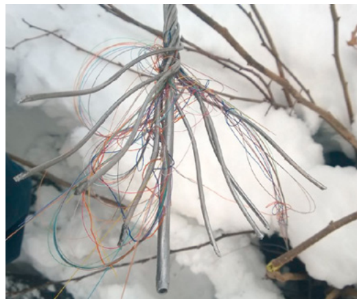
Slika 6. Rasponi prekida OPGW između dva nosiva stuba i mjesto prekida OPGW
