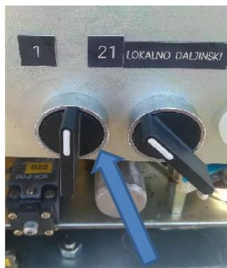
Neispravo zakretno tipkalo
