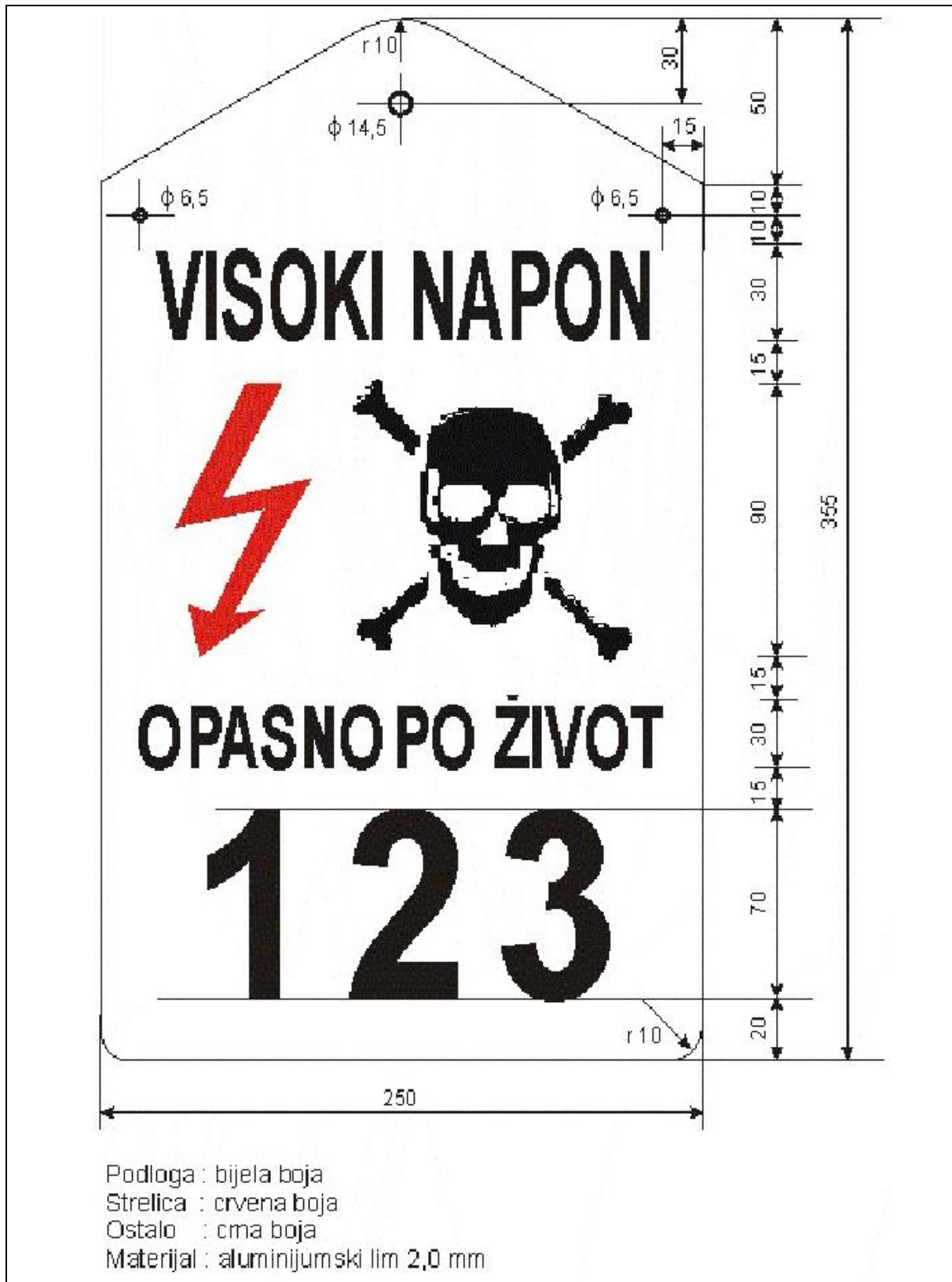
Sl. 6. Izgled tablice sa znakom upozorenja i rednim brojem stuba
