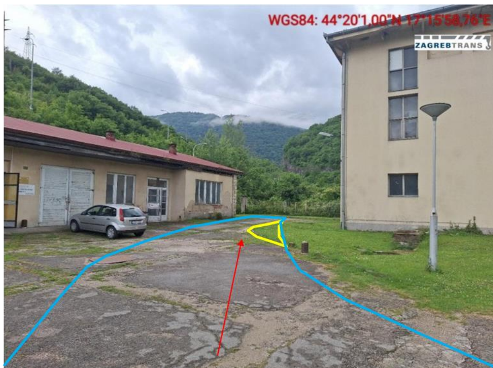
Slika 10- Potrebno ukloniti ivičnjak 1,5m od puta te nasipati, poravnati te zbiti podlogu (60t/m 2 ), potrebno je osigurati put (plava boja) da se sklop težine (91t) ne uruši zbog kanala koji su vidljivi sa slika.
