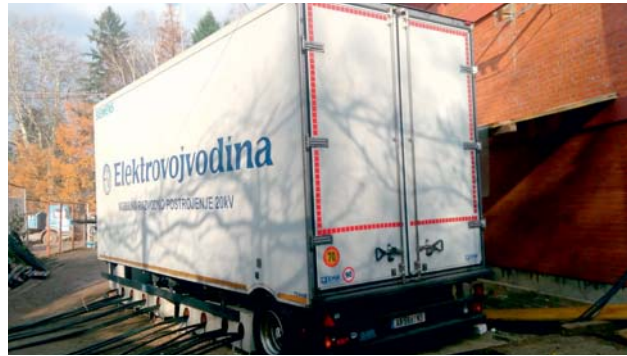
Мобилно разводно постројење 20 kV са примарним везама
