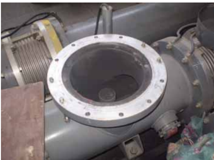
Naponski transformator u Mjernom polju nakon eksplozije
